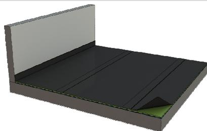
**7)** Poser un polyane (0,2 mm) avec un chevauchement d'env. 20 cm avec les jonctions des matelas. Sur les côtés, le polyane dépassera d'environ 15-20 cm le niveau du plancher fini.
